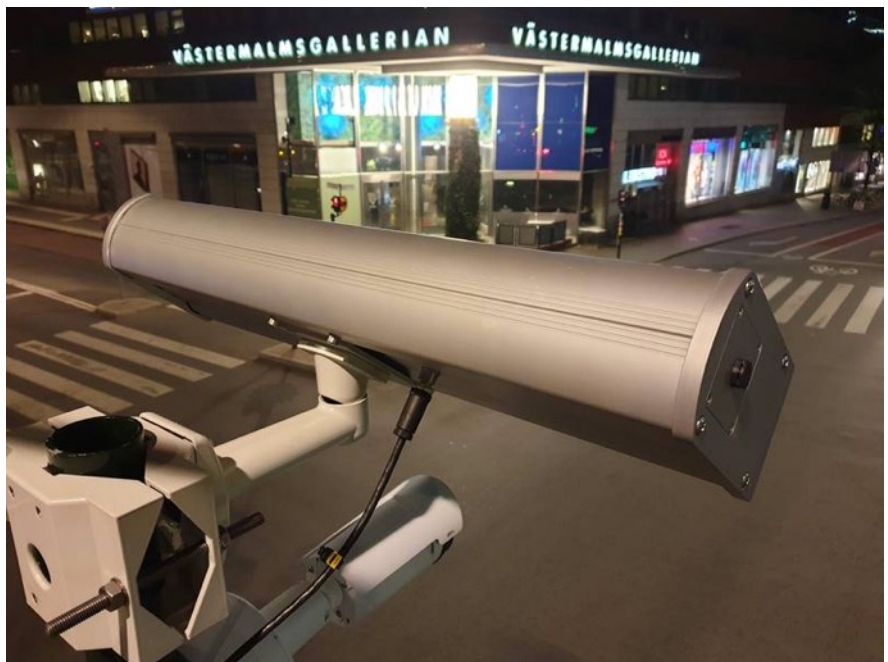
Figur 4: Viscando Otus3D överst och under Axis Q1765-LE Network Camera.
