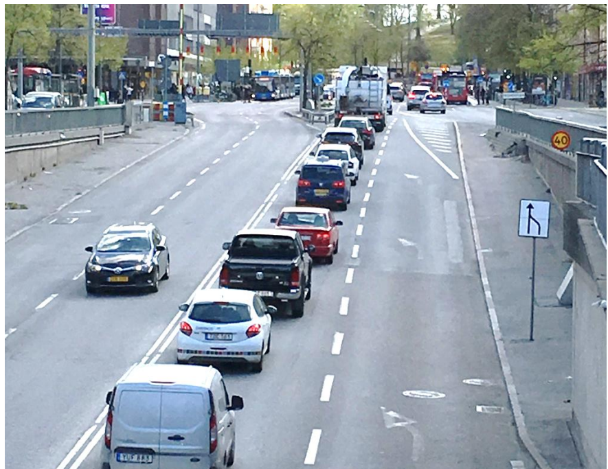
Bild 1 Begräsningar av kapaciteten görs oftast med en kombination av fysiska åtgärder, till exempel färre körfält, och en fast begränsande gröntid i trafiksignalen.
